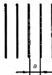
Рисунок 2 – Стенка бункера – расстояние до сетки
