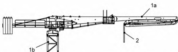
1а – распределительная стрела; 1б – шасси; 2 – концевой рукав трубопровода; 3 – приемный бункер
