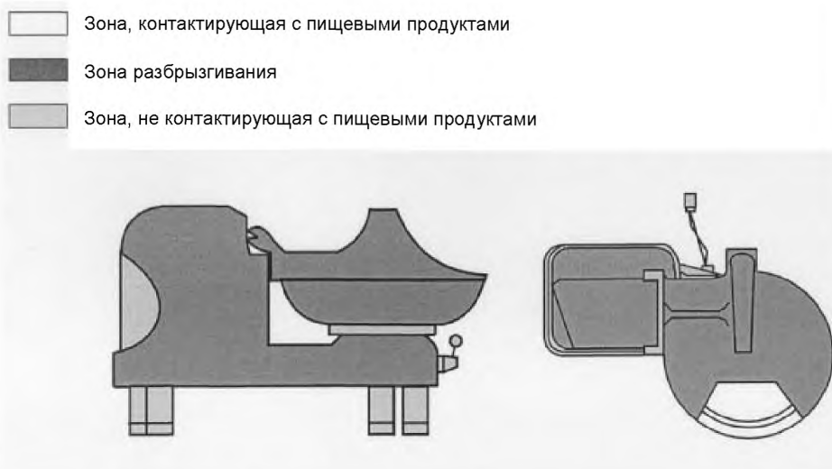
Рисунок 8 – Куттеры типа 1. Зоны, требующие соблюдения гигиенических требований
