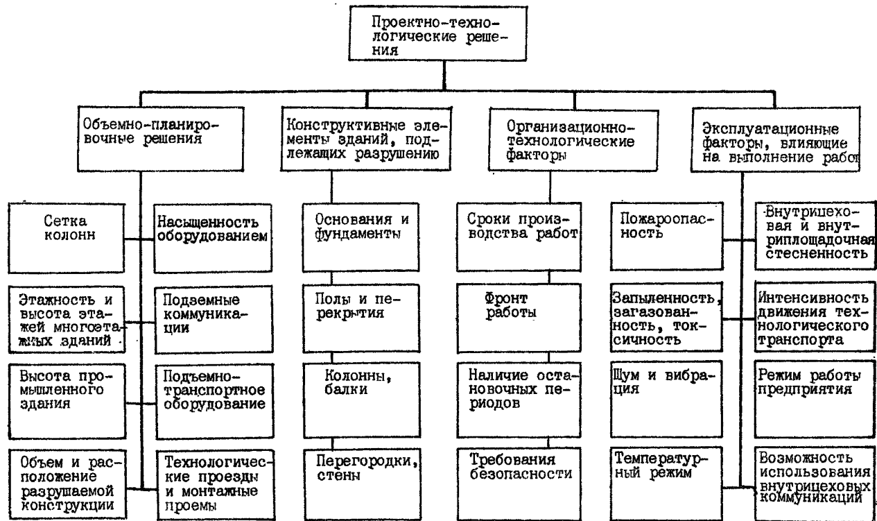
Рис. 1. Факторы, определяющие технологию и организацию производства работ по разрушению строительных конструкций
