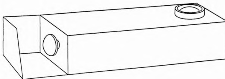
Рисунок А.9 – Разделение защитным кольцевым бортиком, разделительным защитным устройством и ориентацией
