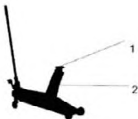
1 – подъемная пята; 2 – подъемная стойка
