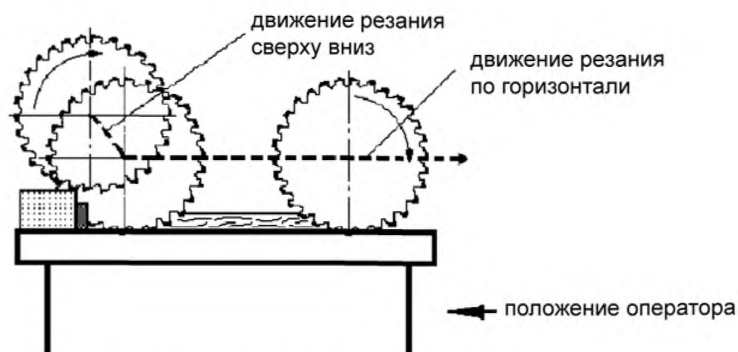
Рисунок 2 – Пример круглопильного станка для торцевания сверху и по горизонтали (защитные устройства не представлены)
