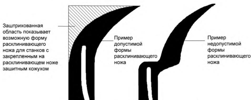
Рисунок 10 – Форма расклинивающего ножа
