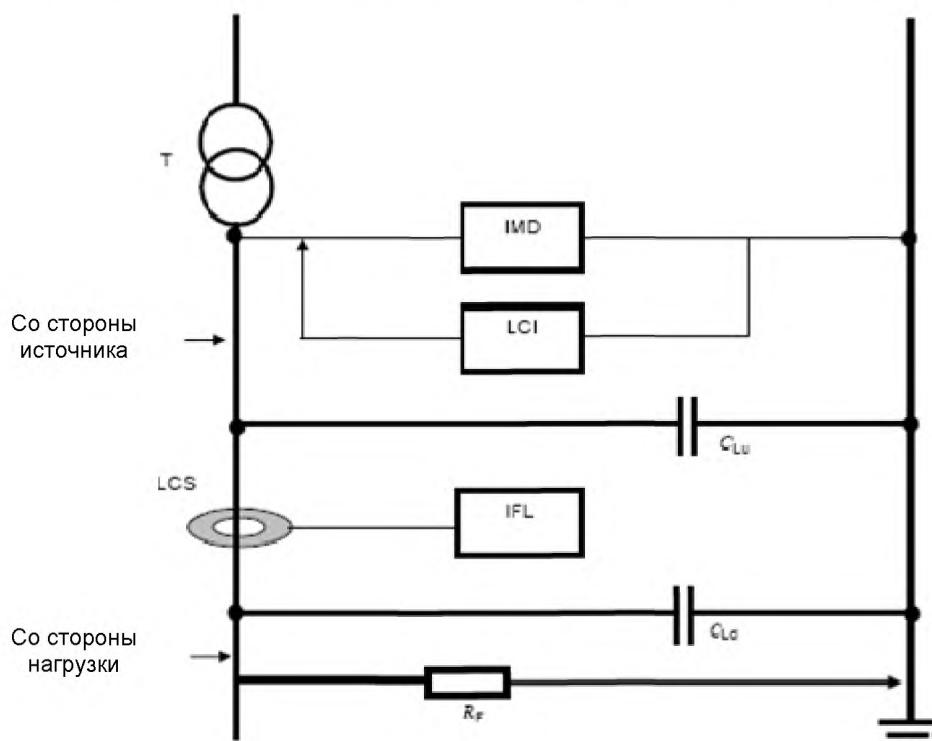
IMD — устройство контроля изоляции;
