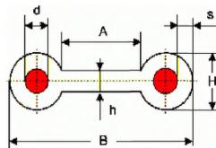
d – диаметр токопроводящей жилы; S – толщина изоляции; A – ширина разделительного основания; В – ширина провода; Н – высота провода; h – толщина разделительного основания
