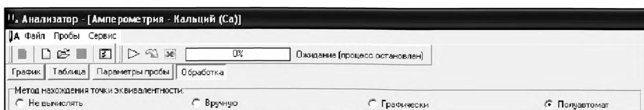
После этого в окне «ОБРАБОТКА» в строке  $C_x$  автоматически считается концентрация кальция в пробе
