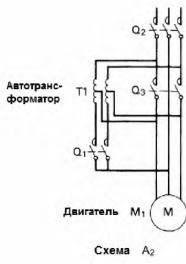
Рисунок 5 – Типичные способы и схемы пуска асинхронных двигателей переменного тока при помощи автотрансформаторов, лист 1
