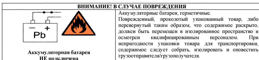
Рисунок О.1 — Предупреждающая наклейка для ИБП, транспортируемых с отключенной батареей
