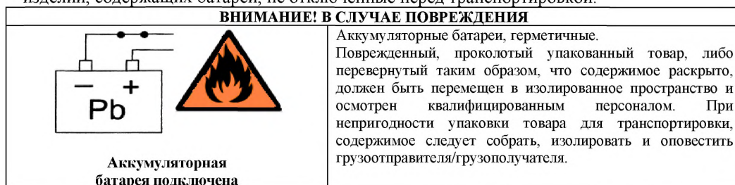
Рисунок О.2 — Предупреждающая наклейка для ИБП, транспортируемых с подключенной батареей
