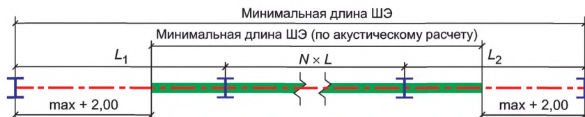
Рисунок 8.1 — Определение максимальной и минимальной длин шумозащитного экрана
