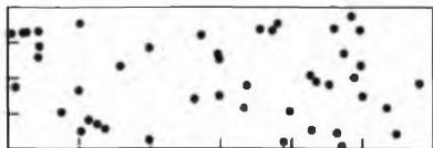
Рисунок А.5 – 3 процента поверхности, 45 пор, d = 1 мм
