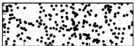
Рисунок А.9 – 16 процентов поверхности, 244 поры, d = 1 мм
