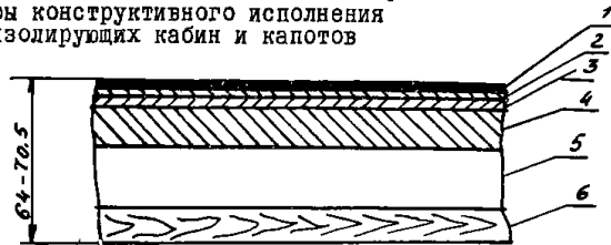
Черт. 1. Перегородка с усиленной звукоизоляцией 1-слой мастики (2-3 мм), 2-стальной лист (1,5 мм), 3-термостумовой картон ТШК-2 (2,5-5,0 мм), 4-звукопоглощающий материал (20мм), 5-воздушный промежуток (30-40 мм), 6-древесно-стружечная плита или пластик (8-10 мм)
