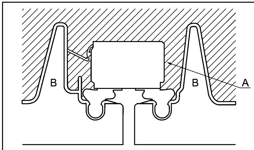
Примечание — В расчете для вращающегося разделителя учитывают закрытые дверцы. Объем внутреннего вращающегося разделителя (А) не учитывают. Выступ на двери (В) не учитывают.
