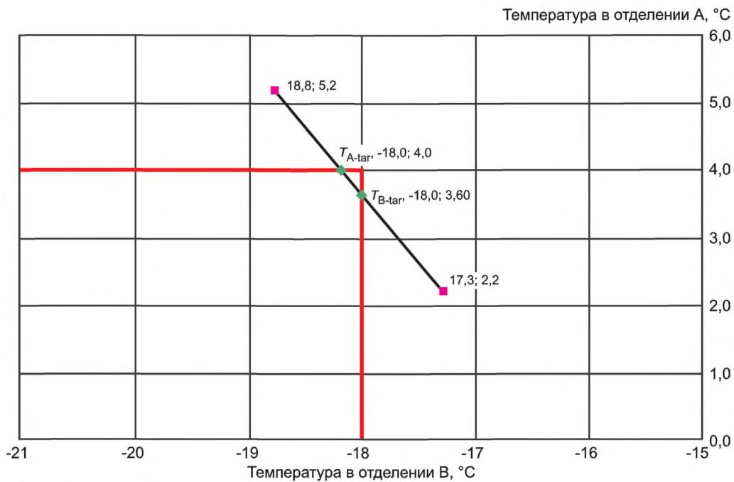
Рисунок I.3 — Пример интерполяции, когда в обоих точках испытаний оба отделения имеют температуру ниже целевой температуры (два допустимых результата)
