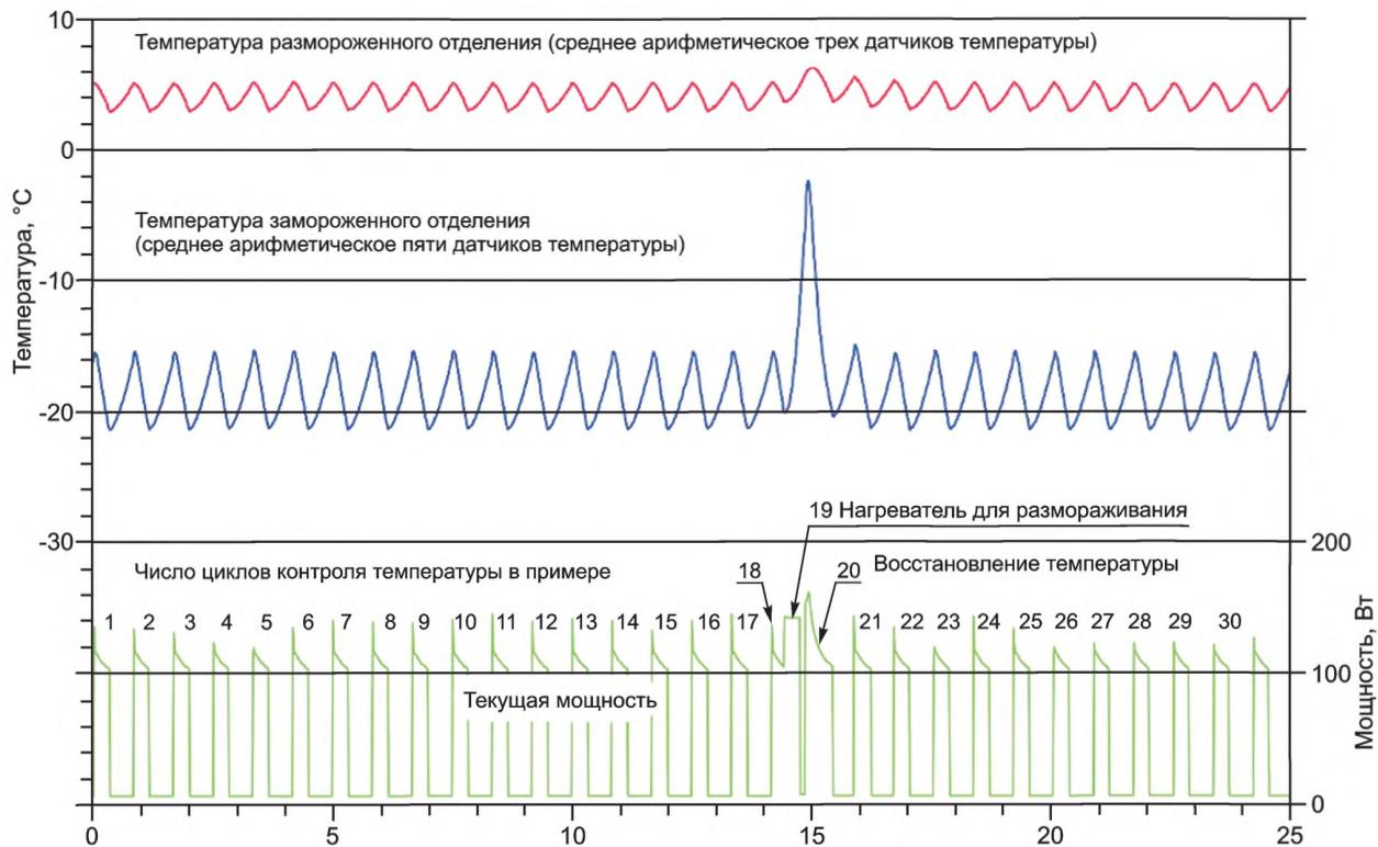
Рисунок I.10 — Пример данных по мощности и температуре
