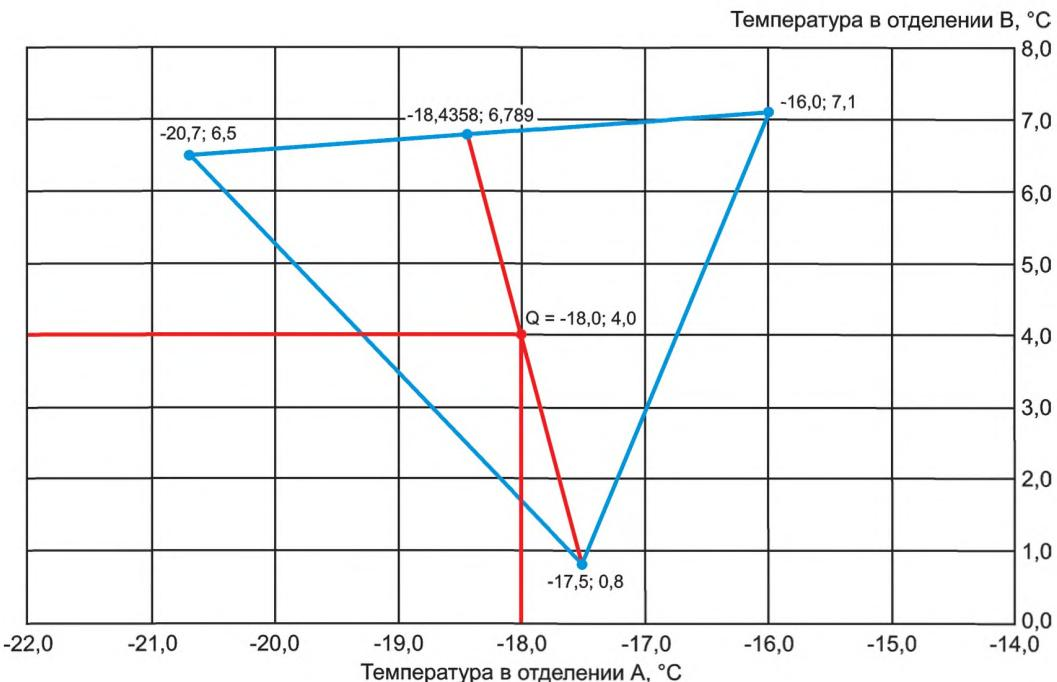
Рисунок I.8 — Пример триангуляции (температуры)
