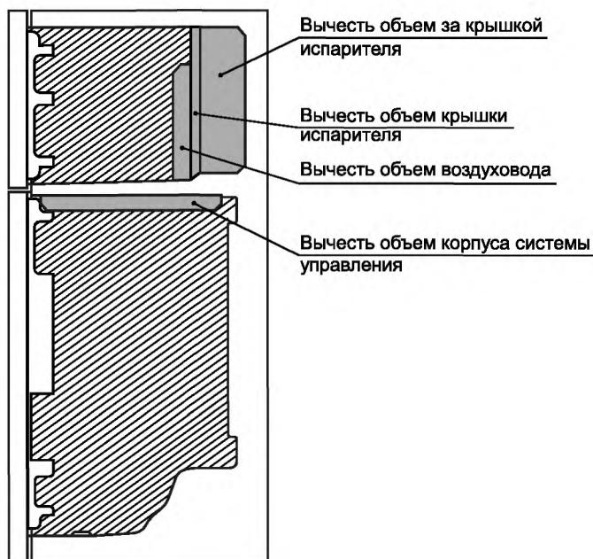
**П р и м е ч а н и е** — Эта схема также относится к приборам с двумя и более дверями, расположенными рядом (side by side), к приборам с расположением **морозильной камеры** снизу, и отдельным **холодильным прибором** с одним **отделением**. Все вычитаемые значения одинаковы. Разъяснение по блоку диспенсера можно просмотреть на следующих рисунках.
