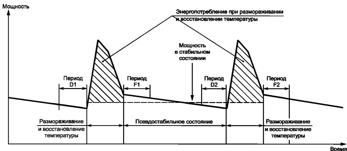
Рисунок K.1 — Особый случай SS2 — когда работа в стабильном состоянии не достигается между периодами размораживания и восстановления и стабильность по приложению С не может быть установлена
