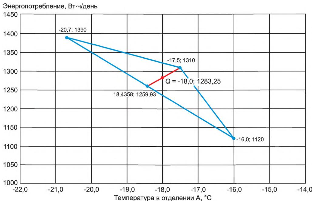
Рисунок I.9 — Пример триангуляции (температура и энергопотребление)
