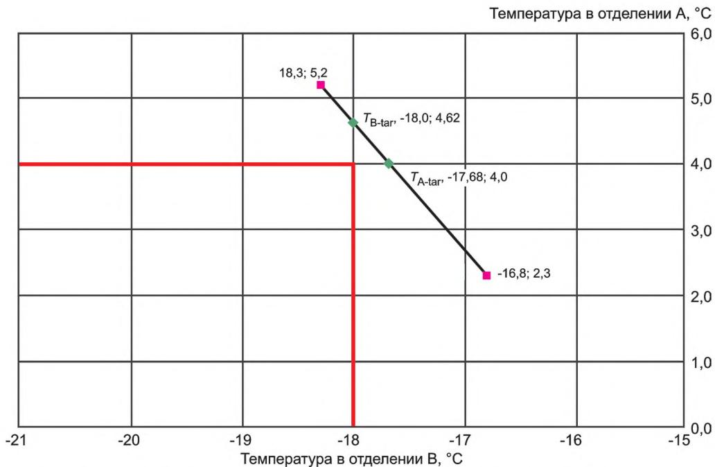
Рисунок I.5 — Пример интерполяции, когда ни в одной из точек испытаний оба отделения не имеют температуру ниже целевой температуры (нет допустимых результатов)
