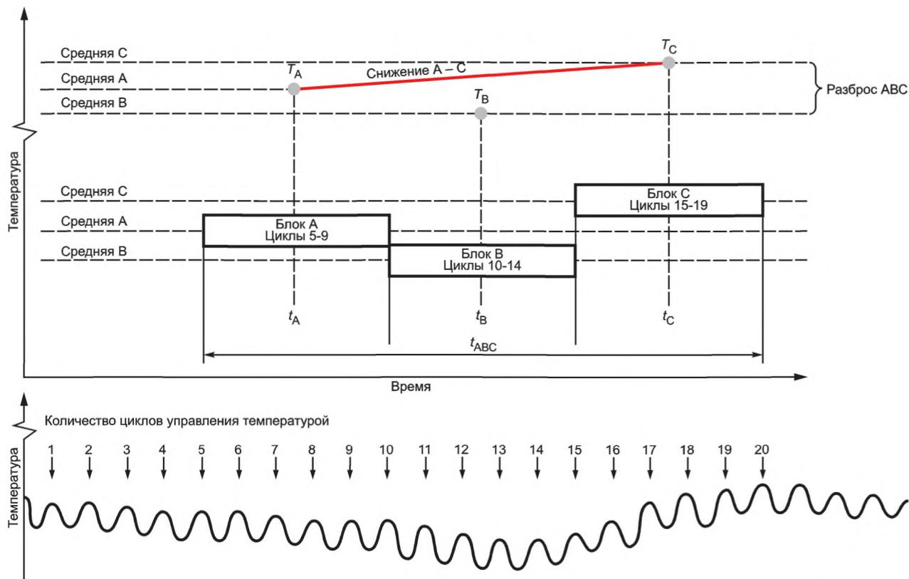
Рисунок В.1 — Иллюстрация периода испытаний из блоков по пять циклов управления температурой.
