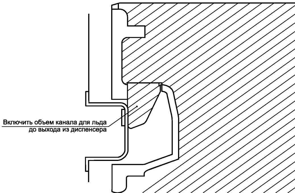
Примечание – Для определения объема с автоматических устройств приготовления льда снимаются заглушки и крышки (например, устанавливаемые при перевозке или в периоды, когда они не используются).
