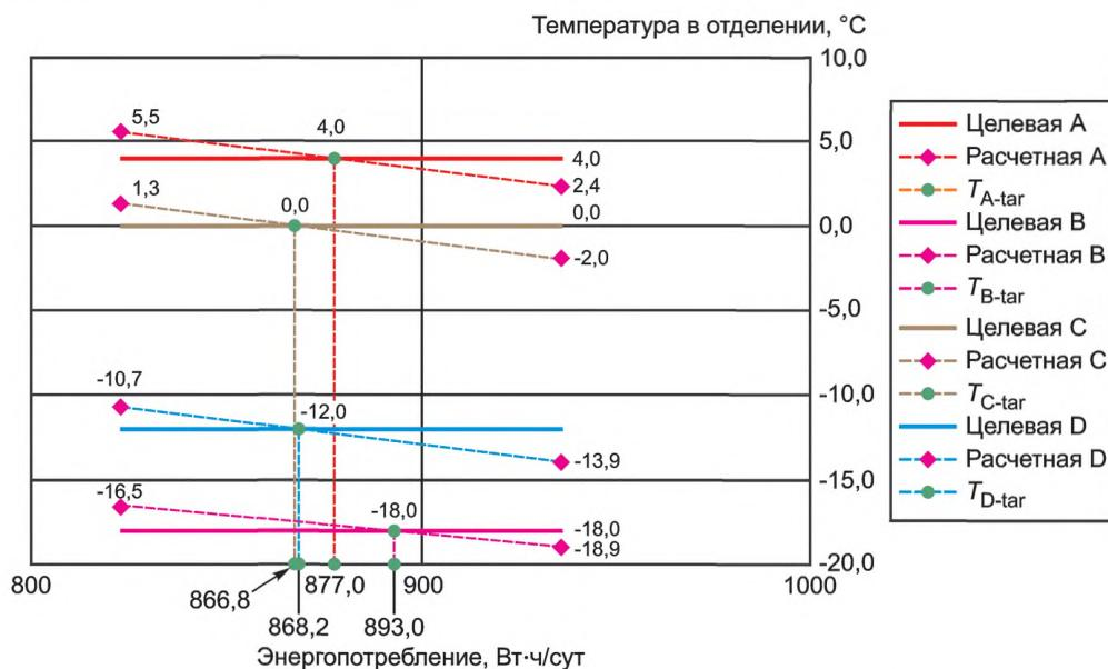
Рисунок I.7 — Пример интерполяции для 4 отделений
