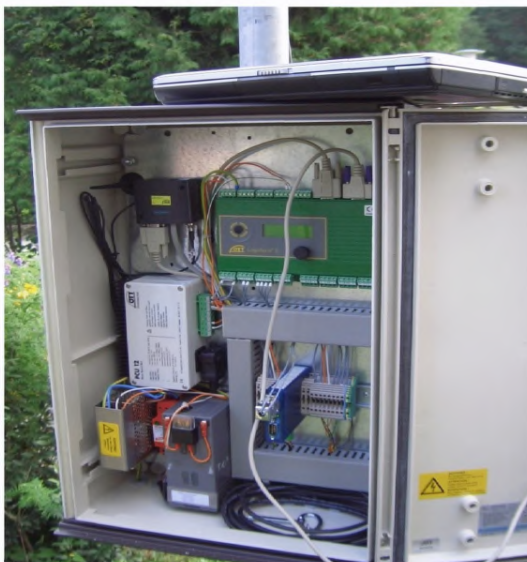
Рисунок 4 – Вид защитного корпуса АГК с монтажной панелью внутри
