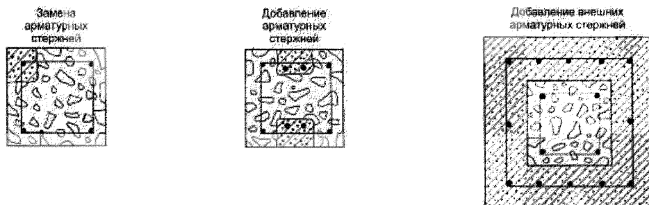
Рисунок Г.4 – Схематичное изображение метода 4.1 после добавления (замены) арматурных стержней
