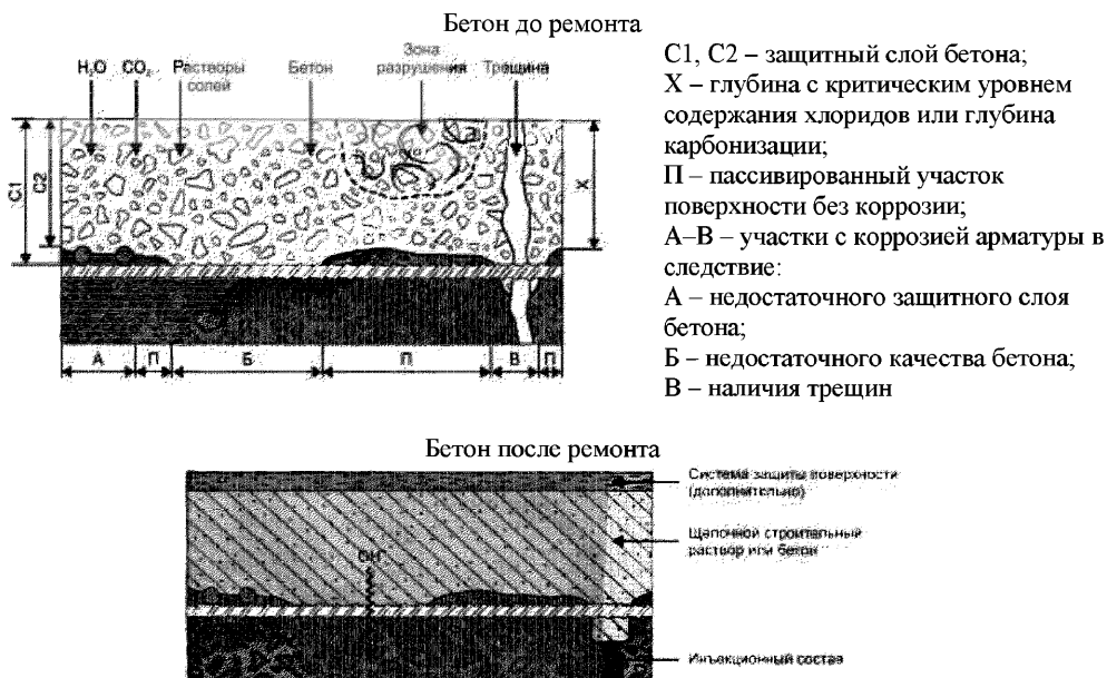
Рисунок Ж.2 – Схематичное изображение метода 7.2 до и после применения
