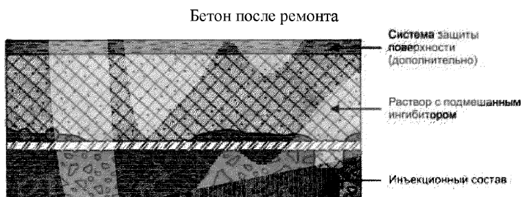
Рисунок К.4 – Схематичное изображение метода 9.3-2 после применения
