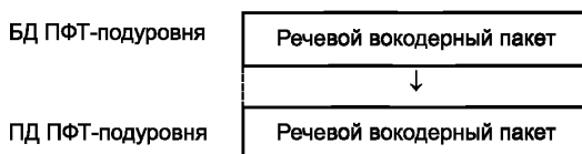
Рисунок 39 — Формирование ПД ПФТ-подуровня из речевого вокодерного пакета
