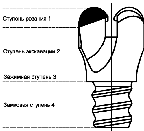
Рисунок 2 — Конструкция бурового резца
