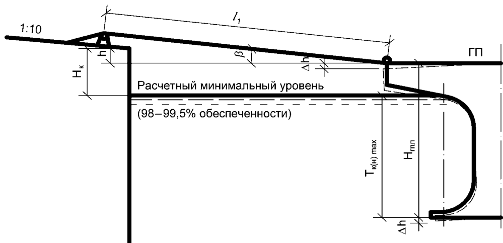
Рисунок 4.2 — Возвышение кордона для судна с прямой рампой в грузу над минимальным уровнем воды 98—99,5% обеспеченности
