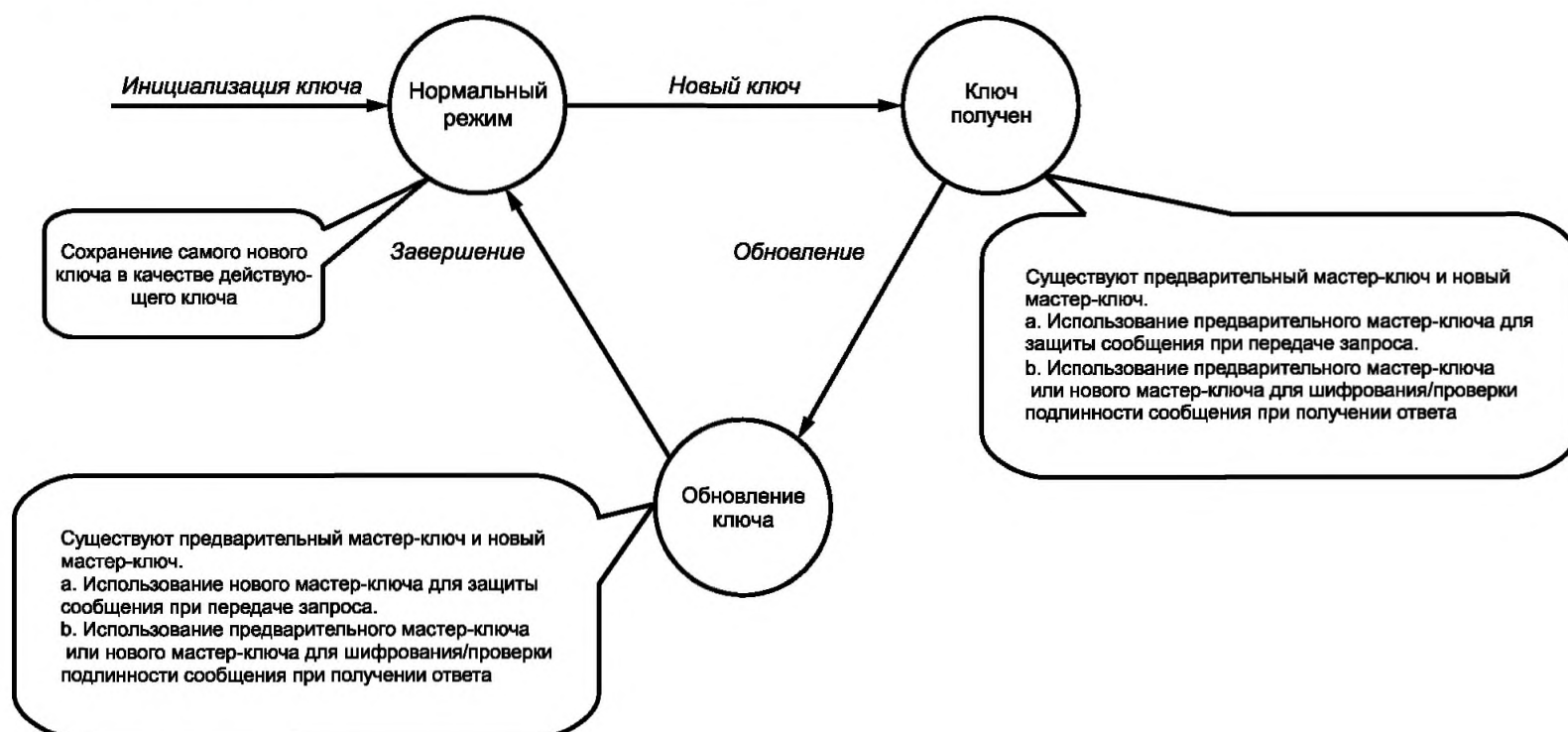
Рисунок 23 — Схема перехода устройства из одного состояния в другое состояние в ходе обновления мастер-ключа под контролем узла KSN
