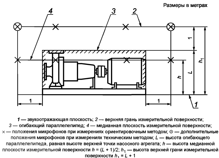
Рисунок 3 — Типовая измерительная поверхность и плоскости, в которых измеряют уровни звукового давления насосного агрегата
