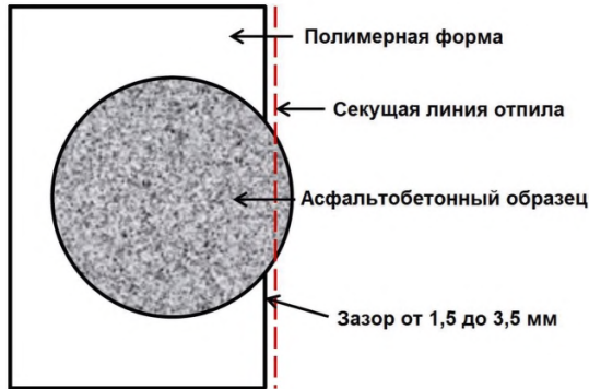
Рисунок 5. Схема обрезки цилиндрических образцов.
