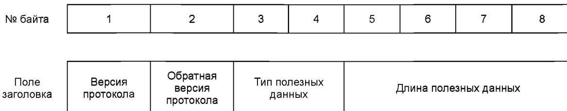
Рисунок 9 — Структура заголовка сообщения V2GTP
