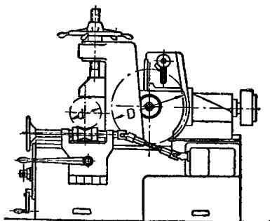
Наибольший диаметр пильного диска  $D$  (мм) . . . . . 275      500      700      1000      1400
