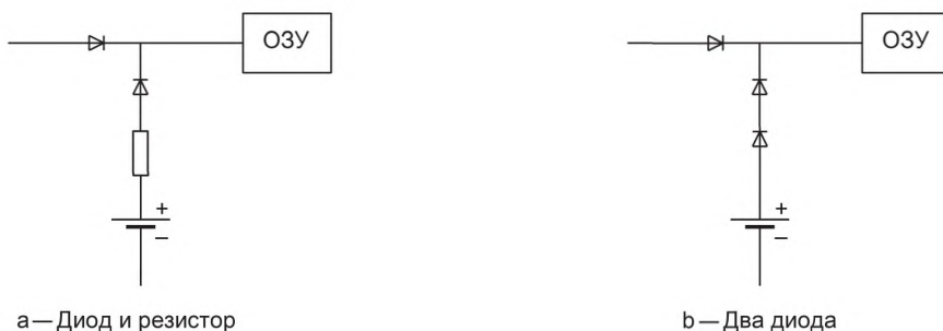
Рисунок 8 — Примеры цепей безопасности для защиты от заряда
