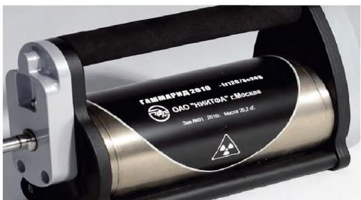
Рассмотрим пример категорирования радионуклидного гамма-дефектоскопа серии «Гаммарид 2010», в состав которого входит закрытый радионуклидный источник излучения на основе иридия-192 с активностью 200 Ки (1 Ки (Кюри) =  $3,7 \cdot 10^{10}$  Бк) на этапе транспортирования.
