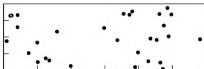
Рисунок А.3 — Пористость 2 %, 30 пор, d = 1 мм
