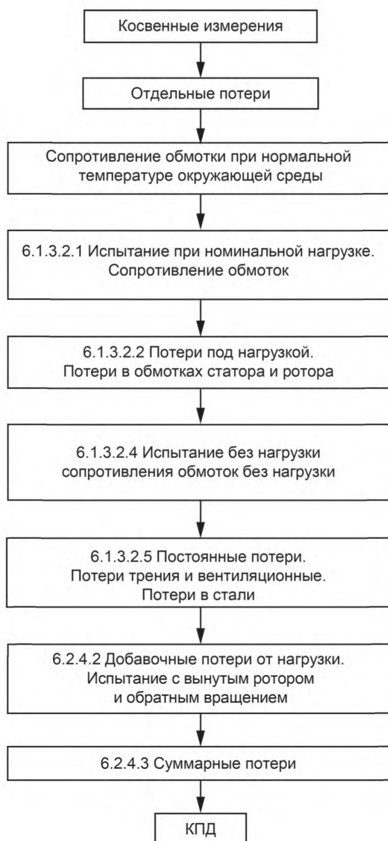
Рисунок 11 — Определение КПД по методу 2-1-1F
