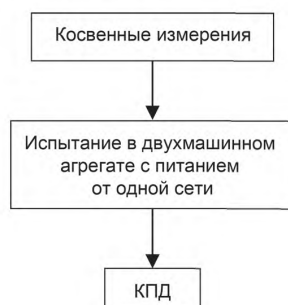
Рисунок 33 — Определение КПД по методу 2-1-3Е
