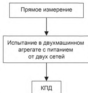
Рисунок 8 — Определение КПД по методу 2-1-1D
