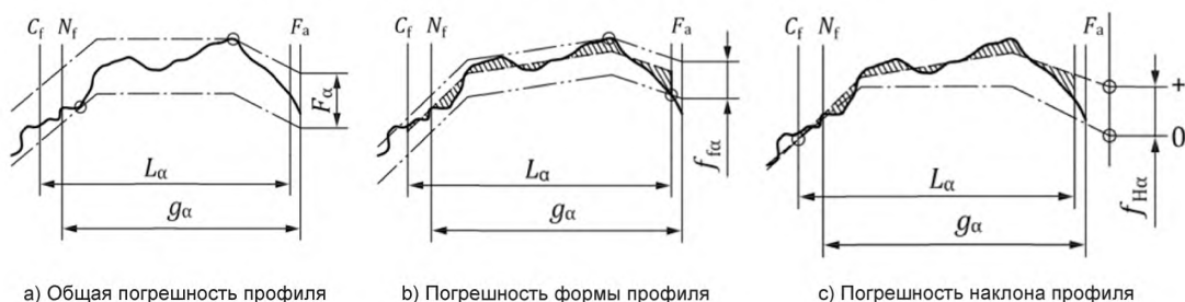
Рисунок 7 — Погрешности профиля с модифицированной головкой
