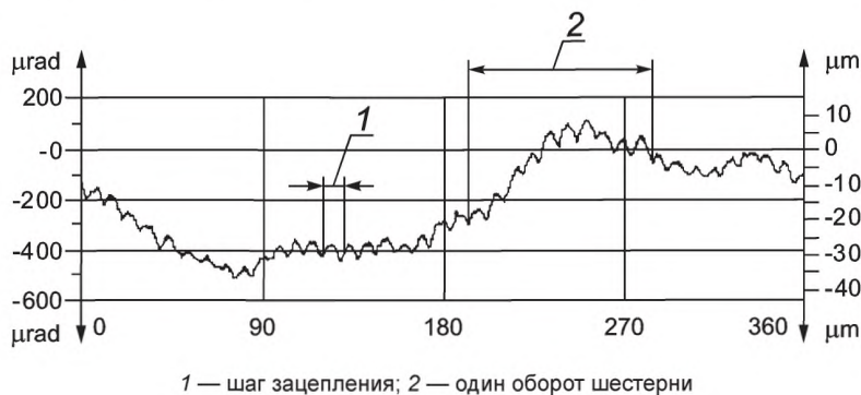
Рисунок F.2 — Пример кинематической погрешности
