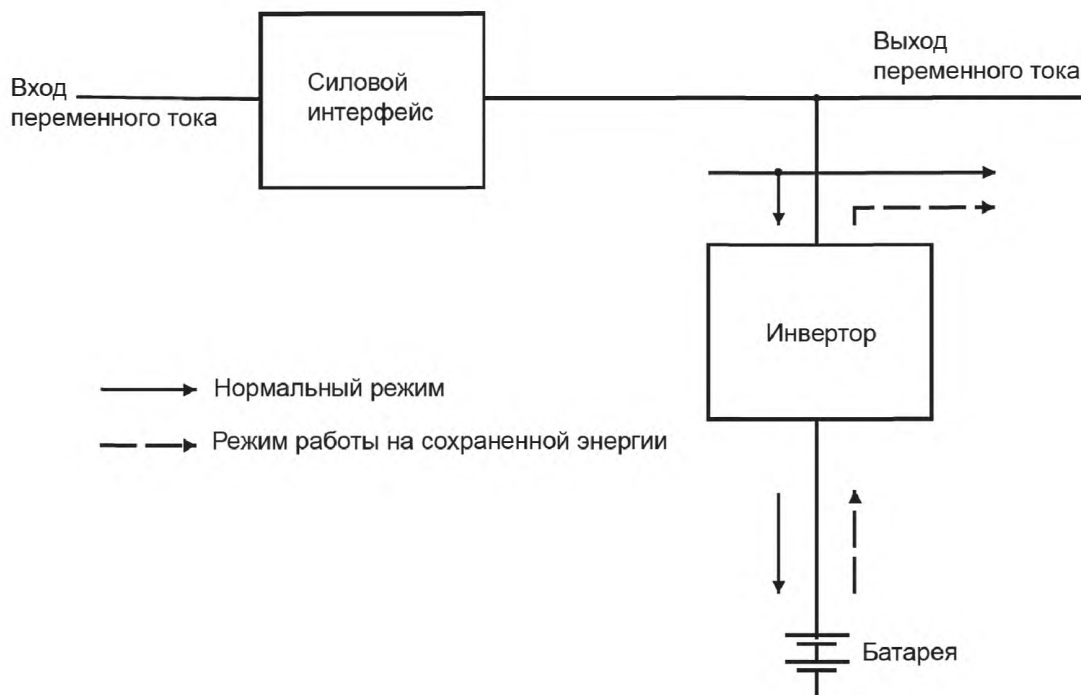
Рисунок В.2 — Линейно-интерактивная топология
