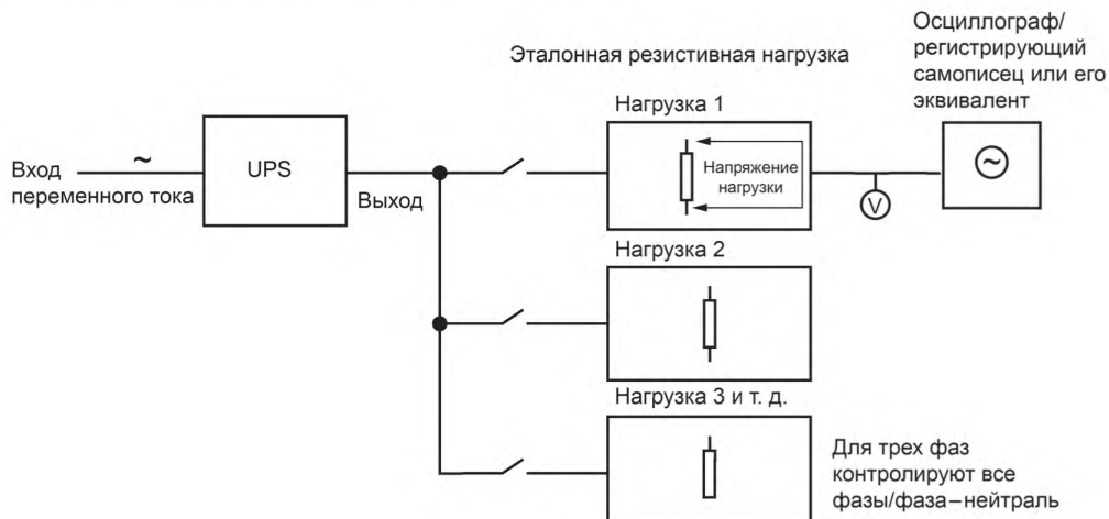
Рисунок 5 — Метод испытаний линейной нагрузки
