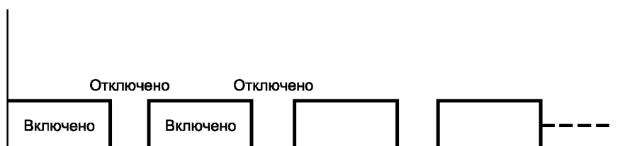
Характерный профиль циклов под нагрузкой/без нагрузки
