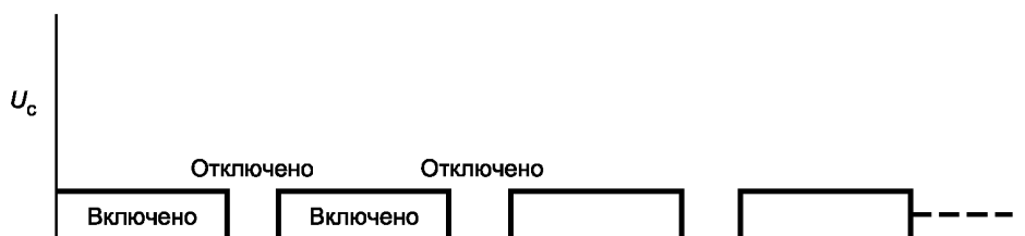
Характерный профиль напряжения управления, U_c
