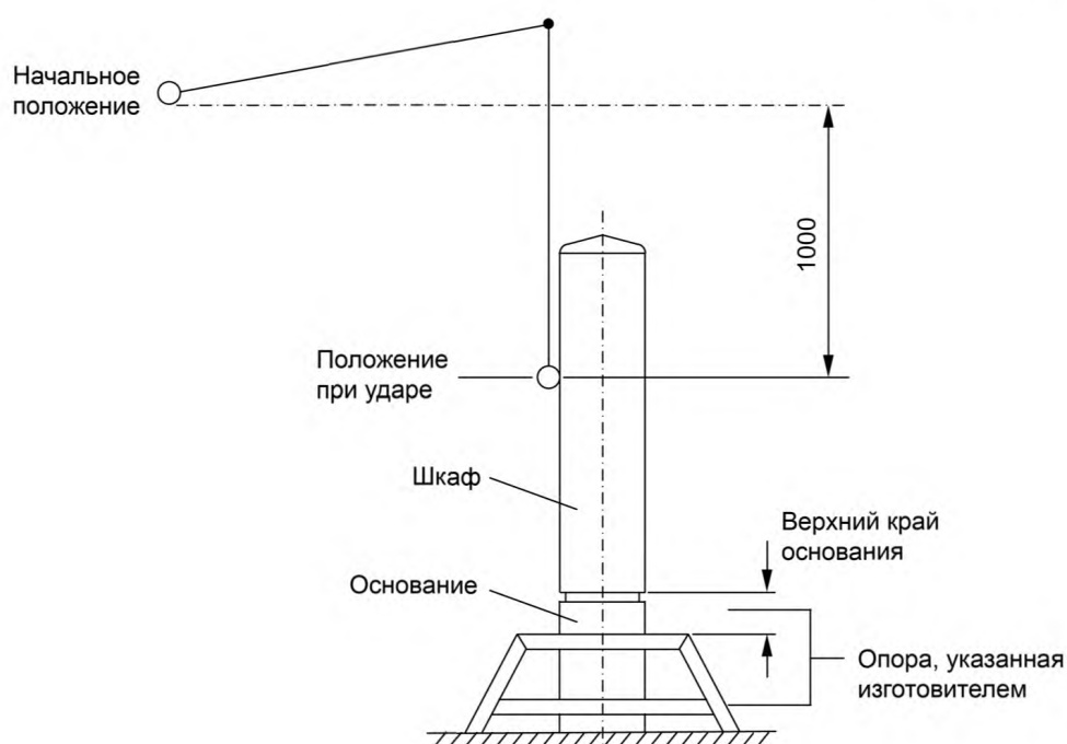
а — Схема проведения испытания для подтверждения стойкости к удару при монтаже НКУ-ОП-Д на земле, зафиксированного в предназначенном для него основании
