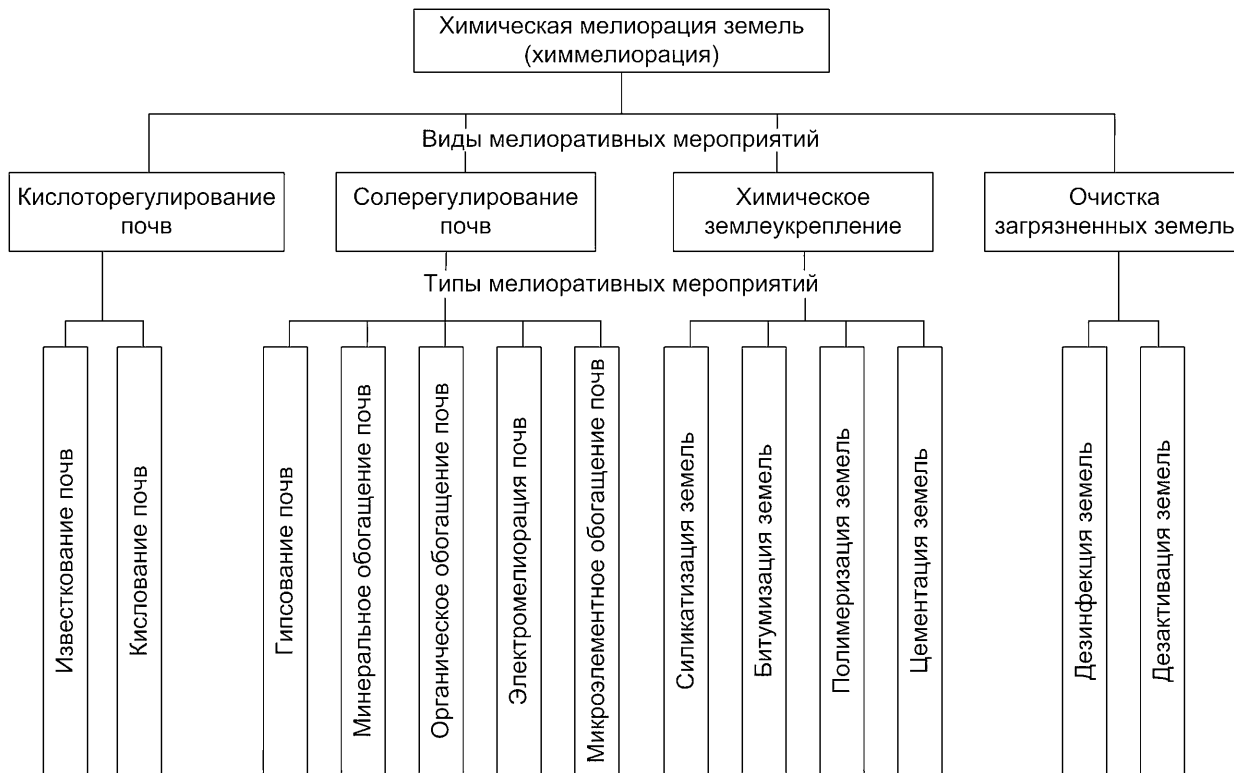
Рисунок А.15 — Классификация по видам и типам мелиоративных мероприятий химической мелиорации земель (химмелиорации)
