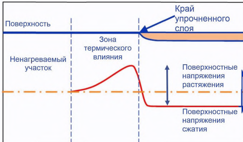
Рис. 4-2. Остаточные напряжения вдоль поверхности шатунной шейки и галтели
