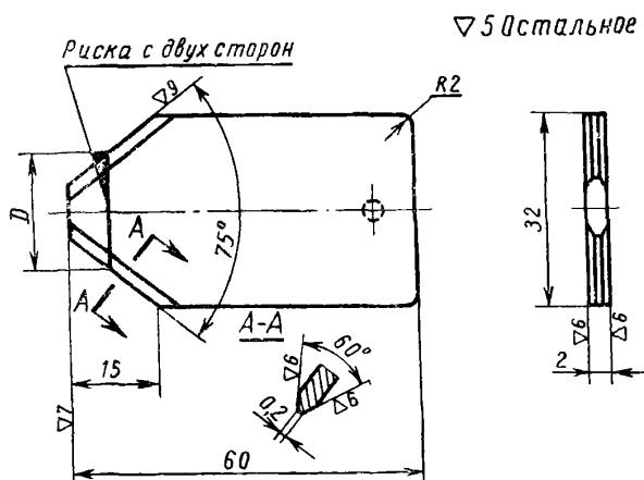
Пример обозначения шаблона  $D=20,5$  мм:
