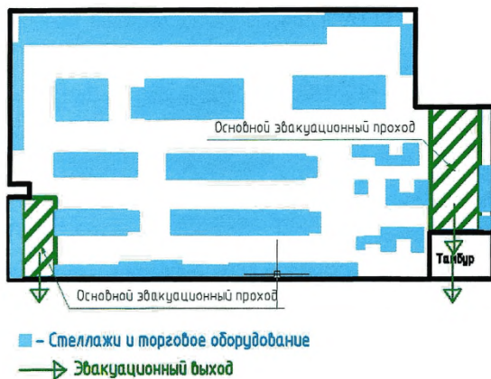
Рисунок А.1 – Пример размещения основных эвакуационных проходов
