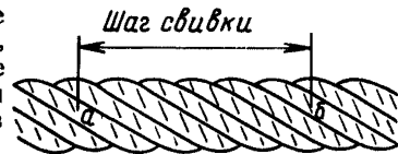
Образец свивки стального каната
