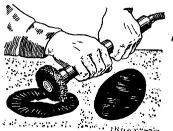
Рис. 39. Шероховка ремонтируемого места с нерабочей стороны ленты.
