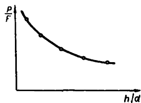
Рис. 15. Зависимость разрушающего значения давления от соотношения размеров образца (при наличии трения торцов)
