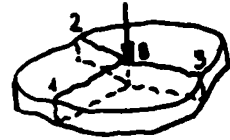
Рис. 37. Определение расчетной площади раскола образца
