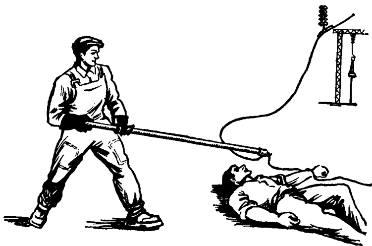
Рис. 6. Освобождение пострадавшего от тока в установках выше 1000 В отбрасыванием провода изолирующей штангой.
