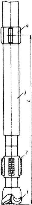
Рис. 39. Компоновка низа бурильного инструмента для бурения участка стабилизации зенитного угла: 1 - долото; 2 - калибратор; 3 - турбобур; 4 - центратор.
