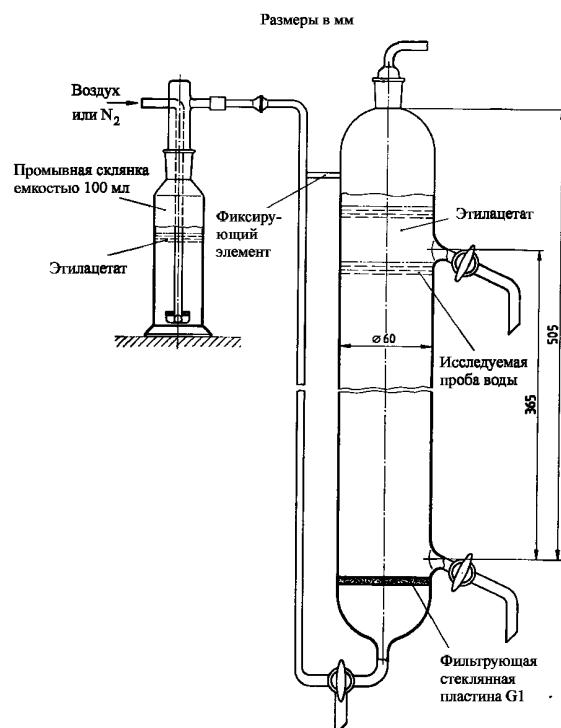
**Рис.1: Аппарат для продувки (см. примечание к 5.3), V = 1 л**
