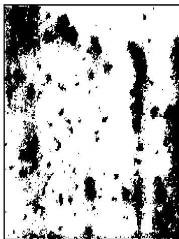
Рисунок А.21 — Коррозия металла — балл К4
