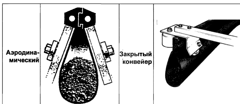
Рисунок 31 – Примеры подвесных ленточных конвейеров
