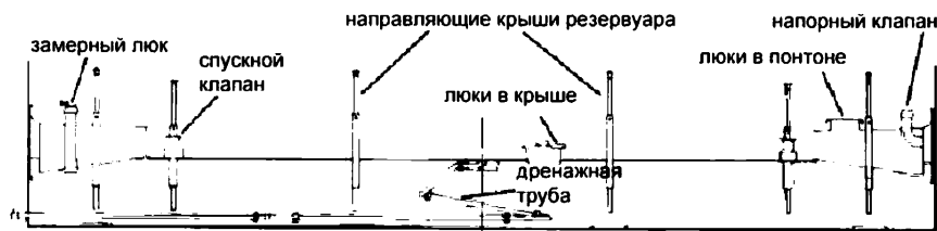
Рисунок 2 – Пример типичной плавающей понтонной крыши
