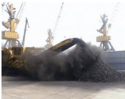
Рисунок 68 – Операции по приведению угля в транспортабельное состояние на ДСК могут сопровождаться обильным пылением
