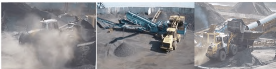
Рисунок 67 – Фронтальные ковшевые автопогрузчики при движении и выгрузке угля из ковша
