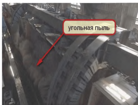
Рисунок 49 – Оборудование СРВ – организованный источник пыления
