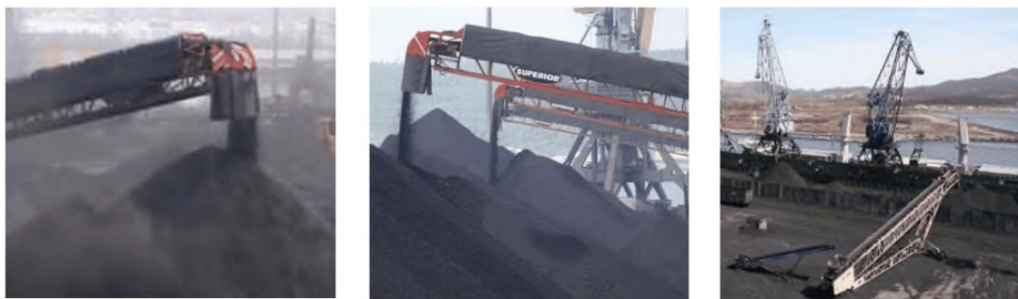
Рисунок 70 –Источники пыления в конвейерных транспортных системах
