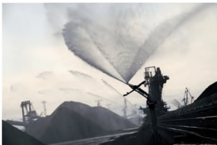
Рисунок 74 – Распыление воды стационарными и мобильными дождевальными (поливальными) установками и гидромониторами
