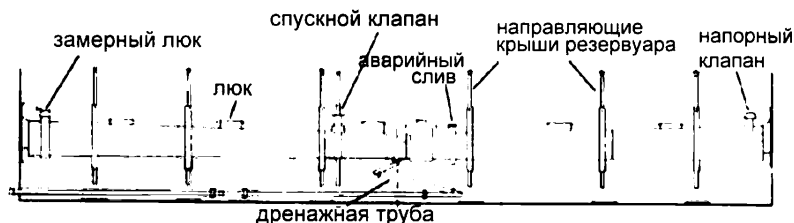
Рисунок 3 – Пример типичной двойной плавающей понтонной крыши
