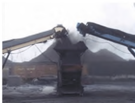
Рисунок 68 – Операции по приведению угля в транспортабельное состояние на ДСК могут сопровождаться обильным пылением
