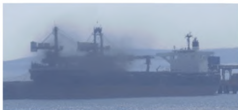
Рисунок 60 – СПМ на МГФ – неорганизованный источник пыления
