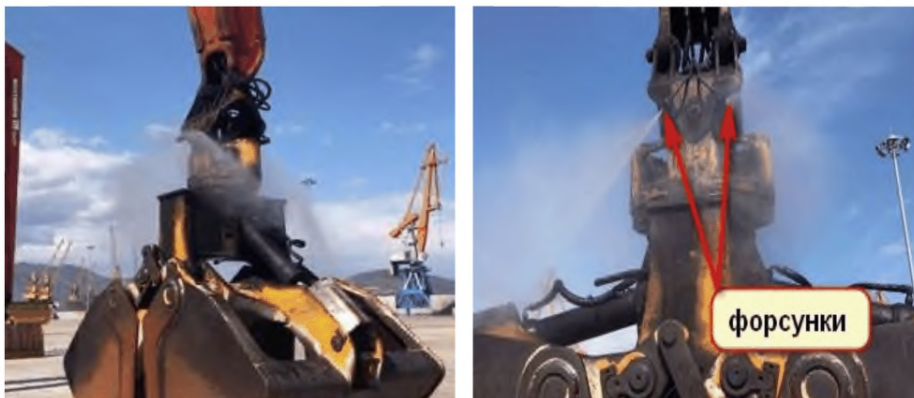
Рисунок 111 – Система пылеподавления на грейфере перегружателя
