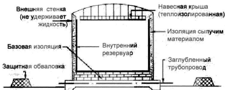
Рисунок 9 – Резервуар с одинарной стенкой
