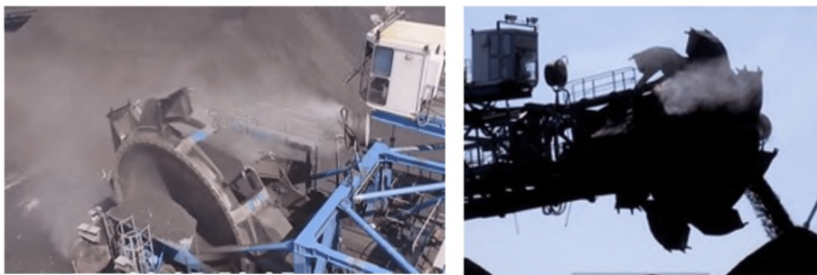
Рисунок 78 – Пылеподавление на рабочих органах стакеров и реклаймерах
