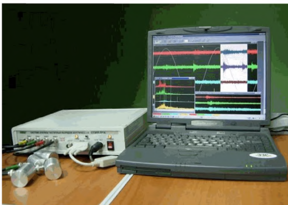
Рисунок 6 - Система анализа ЧР акустическая с портативным компьютером
