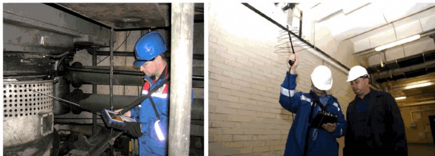
Рисунок Е.1- Локация электрических разрядов в токопроводе с использованием различных сканеров радиочастоты и направленной антенны
