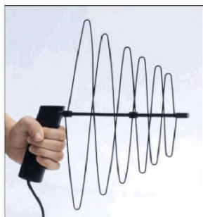
Рисунок Ж.8 – Внешний вид электромагнитной направленной антенны
