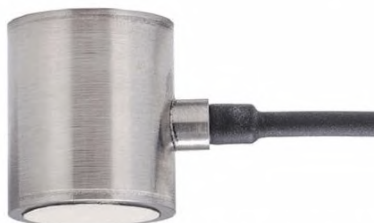
Рисунок Ж.4 – Внешний вид контактного акустического датчика
