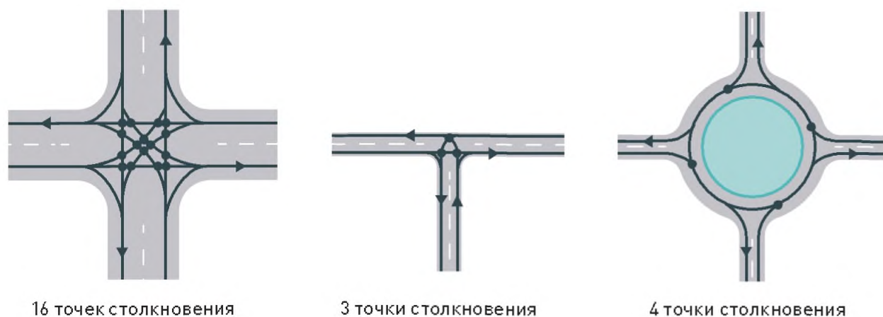
Илл. 176. Количество точек столкновения на Х-образных, Т-образных и кольцевых пересечениях
