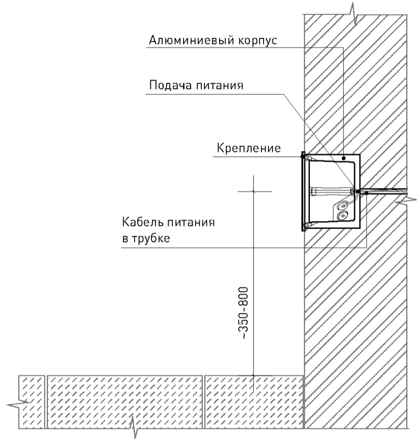
98 Схема установки встроенного светильника на стену / сечение
