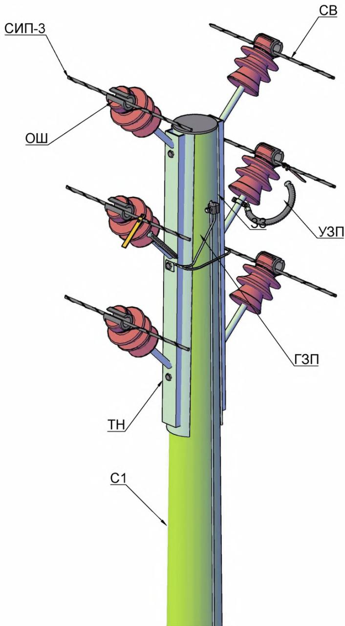
**Спецификация к "5.1.2.Промежуточные двухщепные деревянные опоры ВЛ3 6-20кВ с опорными штыревыми изоляторами и вертикальными траверсами."**
