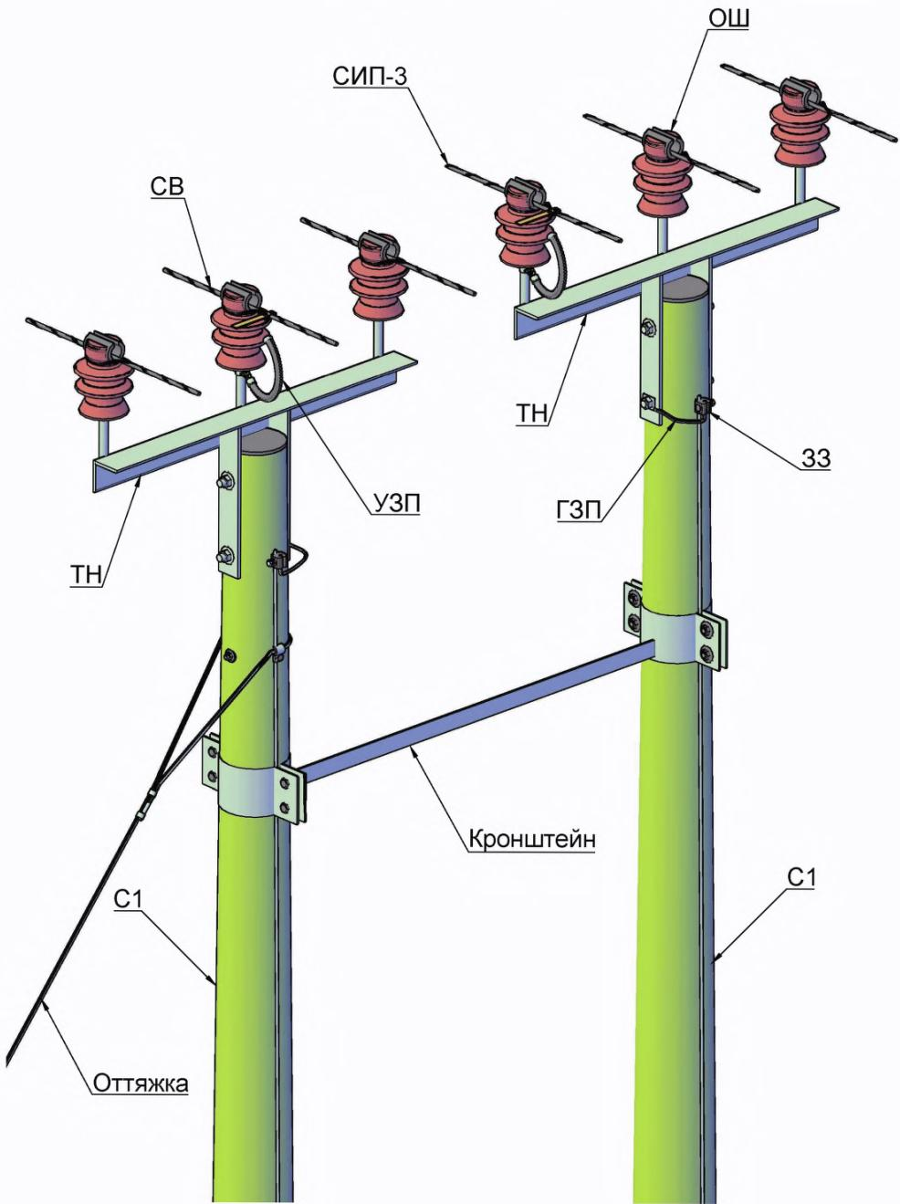
**Спецификация к "5.2.1.Угловые промежуточные двухщепные деревянные опоры ВЛЗ 6-20кВ с опорными штыревыми изоляторами."**
