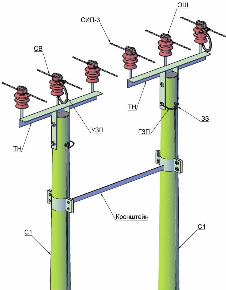
**Спецификация к "5.1.1.Промежуточные двухщепные деревянные опоры ВЛ3 6-20кВ с опорными штыревыми изоляторами и горизонтальными траверсами."**
