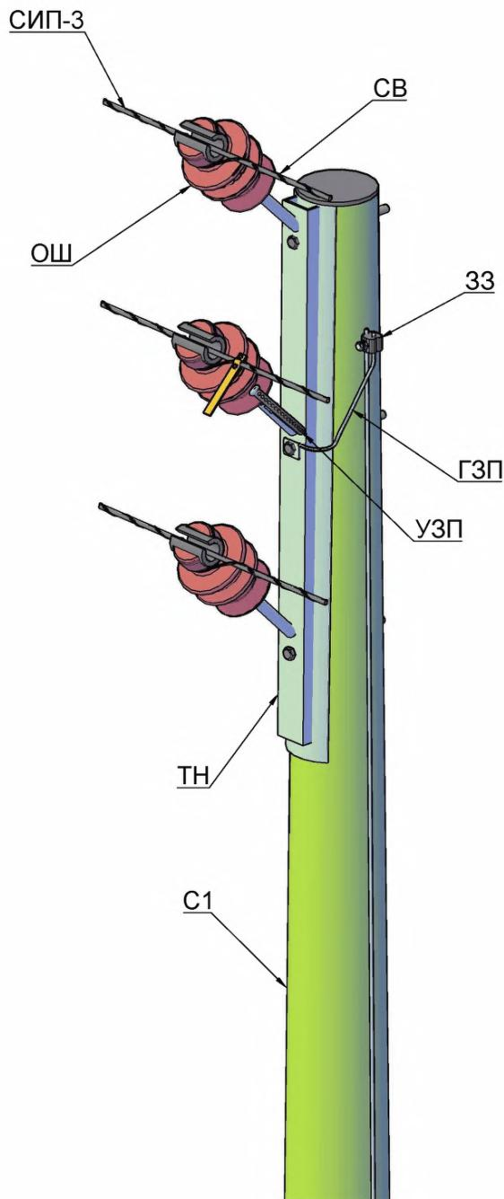
**Спецификация к "4.1.2.Промежуточные одноцепные деревянные опоры ВЛЗ 6-20кВ с опорными штыревыми изоляторами и вертикальной траверсой"**
