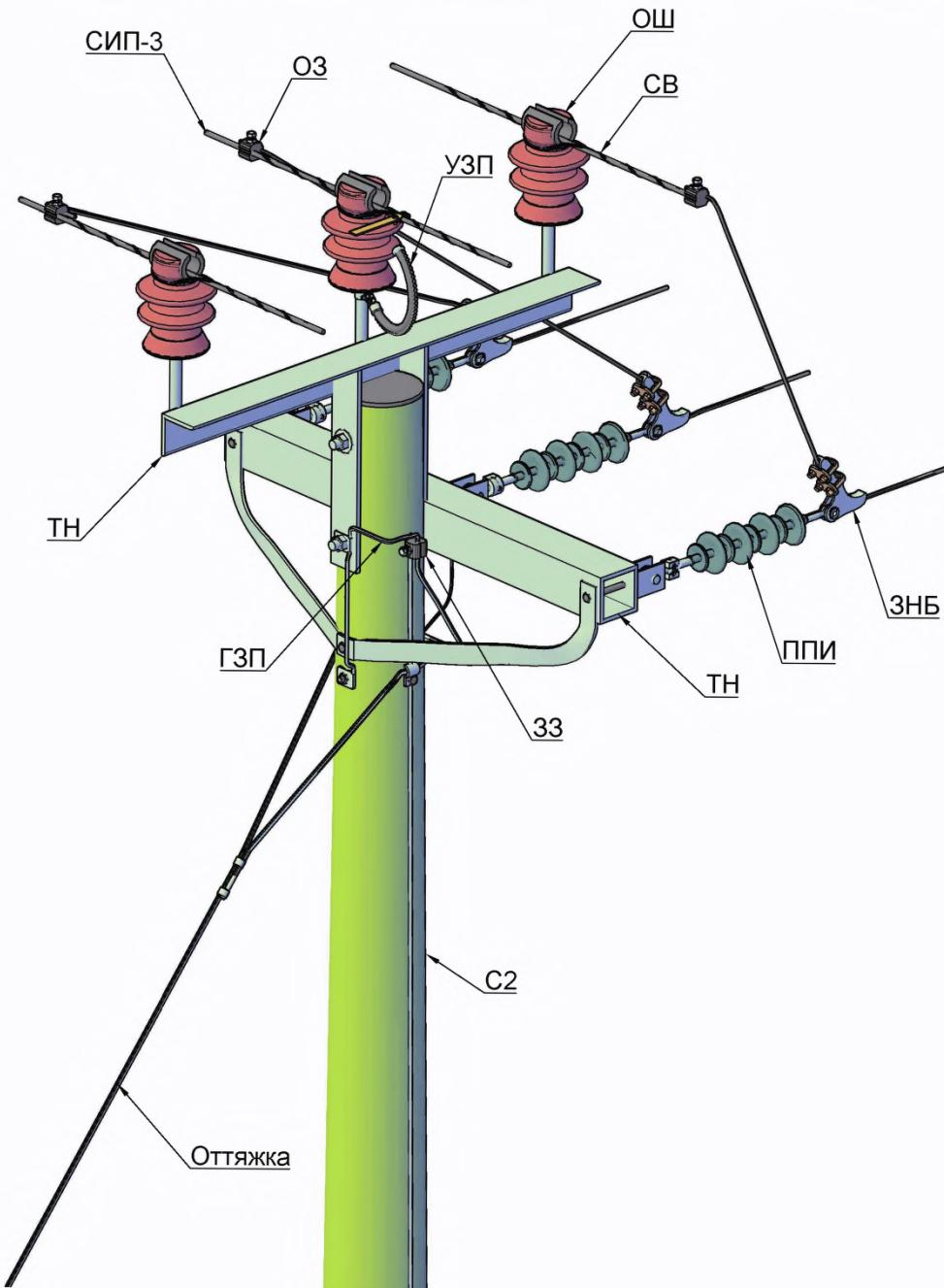
**Спецификация к "4.5.1.Ответвительные промежуточные одноцепные деревянные опоры ВЛЗ 6-20кВ"**
