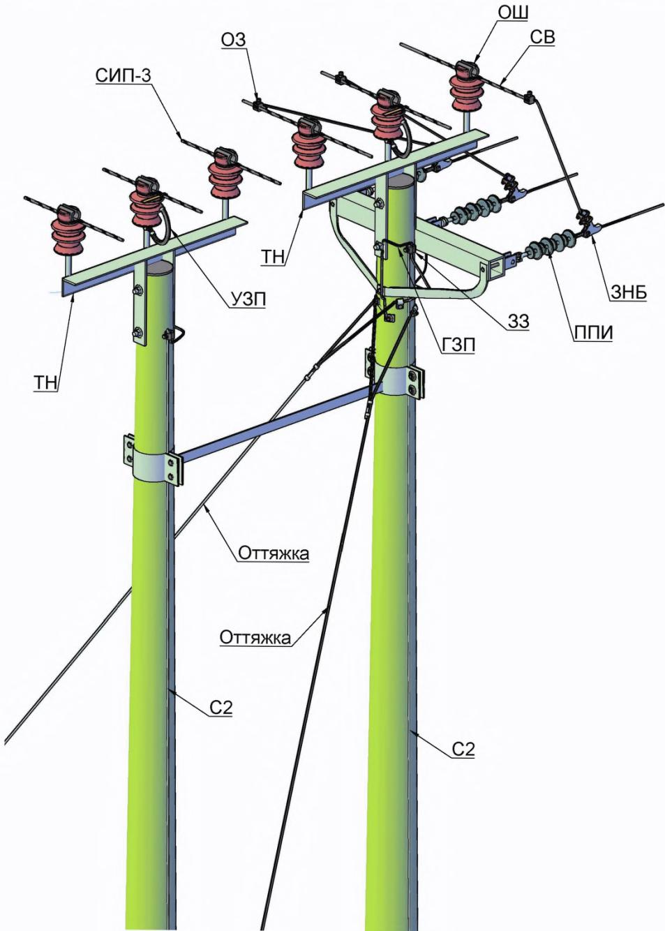
**Спецификация к "5.5.1.Ответвительные промежуточные двухщепные деревянные опоры ВЛЗ 6-20кВ"**
