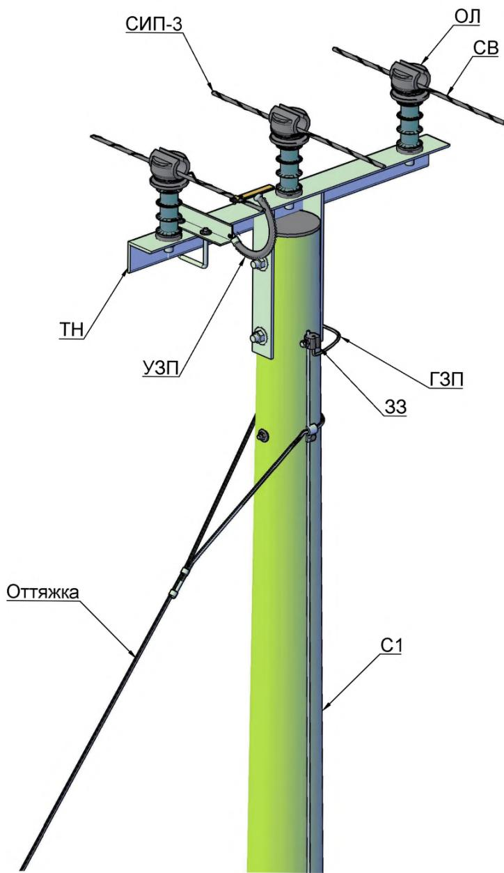
**Спецификация к "4.2.2.Угловые промежуточные одноцепные деревянные опоры ВЛЗ 6-20кВ с опорными линейными изоляторами"**
