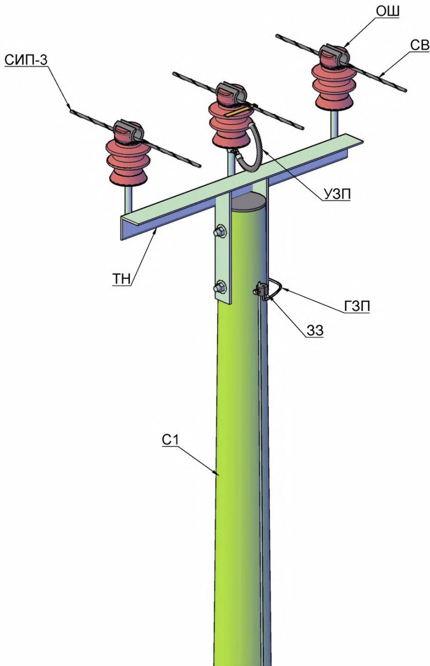
**Спецификация к "4.1.1.Промежуточные одноцепные деревянные опоры ВЛ3 6-20кВ с опорными штыревыми изоляторами и горизонтальной траверсой"**
